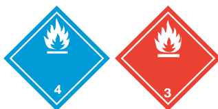
遇湿易燃 易燃液体
